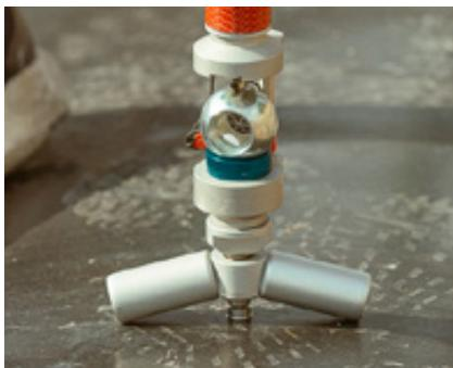
CAGE adapter for ball prism [94](#), Bo 360° Prism [28](#) oder Leica GRZ101 [33](#)
