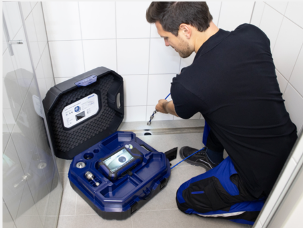
Betrouwbare rioolinspectie dankzij de waterdichte camerakop. De zonneklep zorgt voor goed beeld tijdens zonnige weersomstandigheden.
