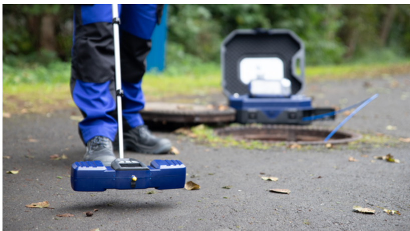
Met de Wöhler L 200 locator kan de camerakop uiterst nauwkeurig gelokaliseerd worden.
