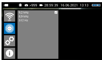
Afb. 33: Lokaliseringssender met 9,2 kHz zendfrequentie geselecteerd
