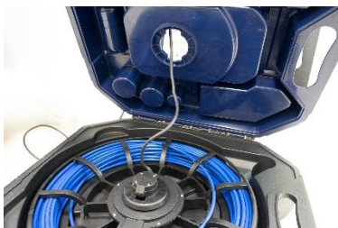
Afb. 61: Fout: camerakabel niet strak getrokken
